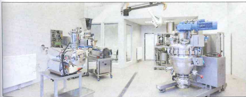
AVA Test Center mit horizontalen und vertikalen Mischern und Trocknern
