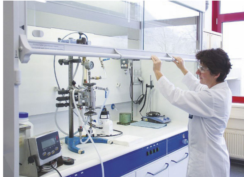
Die Tests im Filtrationslabor von BHS-Sonthofen untersuchen Filtermedium, Betriebsdruck und Kuchenstärke, um das optimale Design und die Größe des Filtrationssystems zu bestimmen
